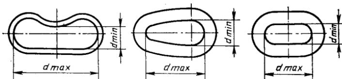
Не допускается деформировать трубы при переходе от одного направления к другому.
