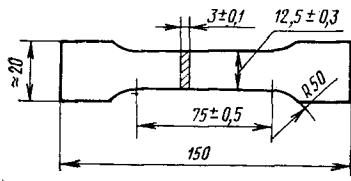
4.5.7.1. Для проведения испытания применяют разрывную машину, обеспечивающую:
