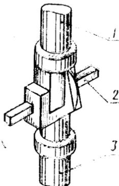
штанги в рабочей части 30 мм, ширина каждой стороны нижней штанги 25 мм.
