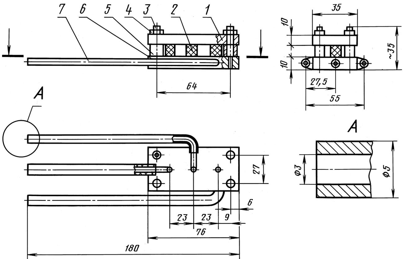
1 — верхняя плита; 2 — образец; 3 — болт; 4 — гайка; 5 — ограничитель; 6 — нижняя плита; 7 — отводная металлическая трубка
