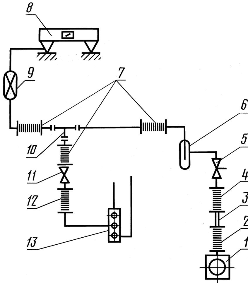
1 — вакуумный насос; 2, 4, 7, 12 — резиновые вакуумные трубки; 3 — металлическая труба; 5 — трехходовой кран; 6 — ловушка; 8 — вакуумметр; 9 — манометрический преобразователь; 10 — тройник; 11 — двухходовой кран; 13 — струбцина
