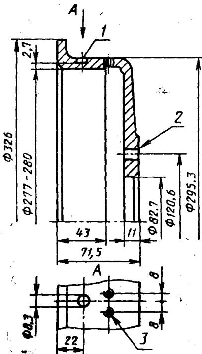
1 — отверстие под плоскую термопару;
