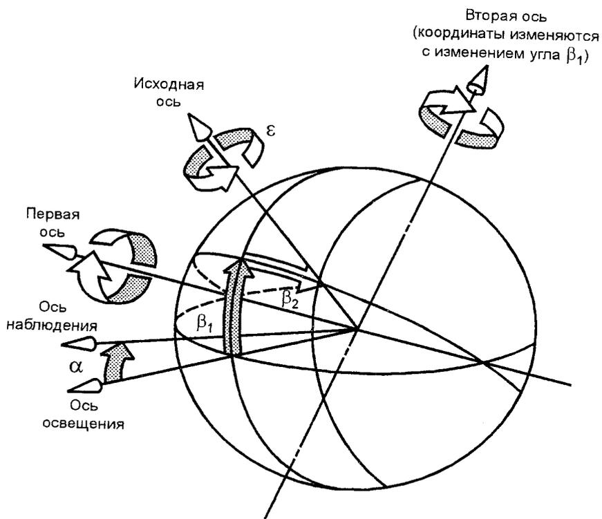
Система углов МКО для определения и измерения светоотражения. Первая ось перпендикулярна к плоскости, в которой проходят ось наблюдения и ось освещения. Вторая ось перпендикулярна как к первой оси, так и к исходной оси. Все оси, углы и направления вращения показаны положительными.
