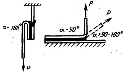
52. **Прочность клеевого соединения при сдвиге**
