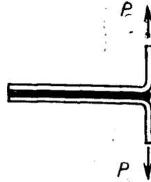
51. **Прочность клеевого соединения при отслаивании**
