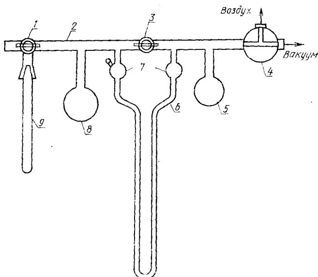
рообразными расширениями 7 в верхней части для улавливания масла; пробирки 9 для образца длиной 180 мм внешним диаметром 17—18 мм; вакуумного насоса типа НВР по ГОСТ 14707—82 или другого, имеющего аналогичные характеристики; нагревательного устройства; автотрансформатора регулировочного типа ЛАТР-2; ртутного манометра с ценой деления шкалы 1 мм, термометра по ГОСТ 215—73 группы 1 № 4 или 5.
