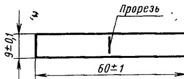
принимают соответствующие размеры штанцевого ножа. Условия вырубания образцов должны соответствовать ГОСТ 269—66, разд. 1.
