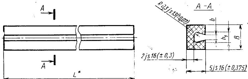
\* Размер  $L$  определяется технологическими возможностями изготовителя.
